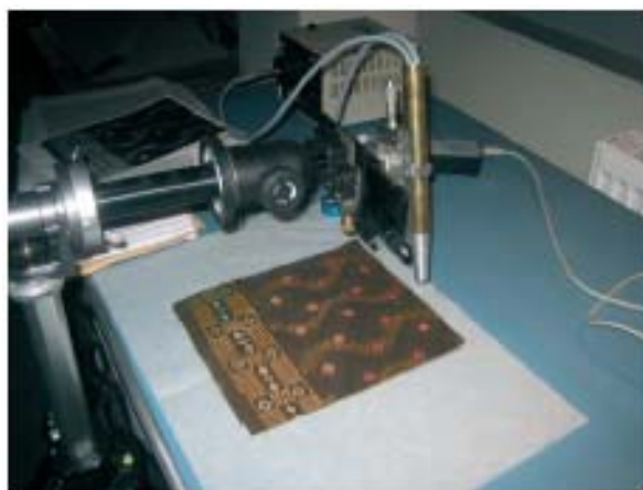
Fig. I-10 : Photo du GOSPEL en cours d'utilisation pour des mesures de spectrométrie sur des Indiennes
